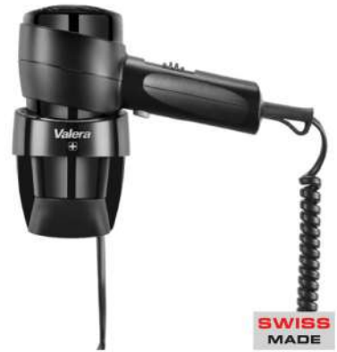
Valera Action Super Plus 542.14/038A All Black Siyah, spiral kablolu, 2 üfleme hızlı, üç sıcaklık ayarlı, duvara monte, tetikli modeldir. 1800 W, 220V-50Hz
