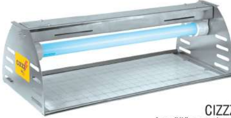
CIZZZ KYF 40 Ampüllü, yapışkanlı sinek öldürme cihazı, 304 paslanmaz çelik, dekoratif. 220V/50 Hz 1x40 Watt (Kısa ampül) Tesir alanı:30 m2, 625x300x210mmh
