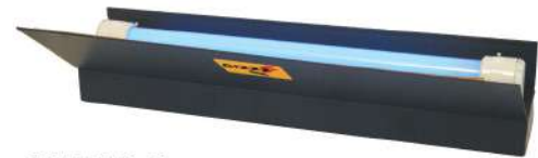
CIZZZ KY 40 Ampüllü, yapışkanlı sinek öldürme cihazı, 304 paslanmaz çelik, siyah, duvar tipi. 220V/50 Hz 1x40 Watt ampül Tesir alanı:20 m2, 640x240x140mmh
