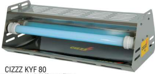
CIZZZ KYF 80 Ampüllü, yapışkanlı sinek öldürme cihazı, 304 paslanmaz çelik, dekoratif. 220V/50 Hz 2x40 Watt (Kısa ampül) Tesir alanı:50 m2, 625x300x210mmh
