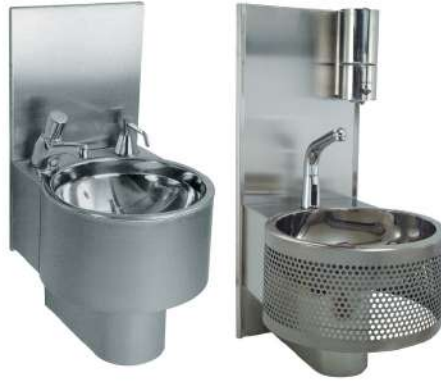
YIBTECH STR D 50-STR DD 40 Dekoratif yuvarlak el yıkama evyesi. 304 saten paslanmaz çelik, düz veya delikli model, duvara monte, isteğe göre aksesurlar dahil edilir. 410x520x800 mmh
